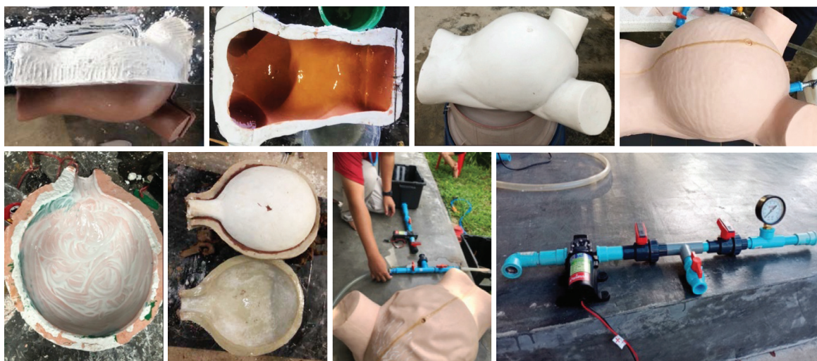
ภาพที่ 1 แสดงการสร้างหุ่นภายนอก (ผนังหน้าท้อง และการสร้างถุงจำลองการหดตัวของมดลูก)
